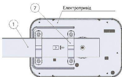
Приклад кріплення приводу до шини.
